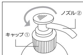
キャップ①を固定し、ノズル②を矢印の方向に回すと、ポンプが上がります。液が出るまで数回押してください。
